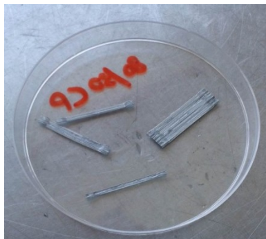
Fibre anticorrosione, prova superata
