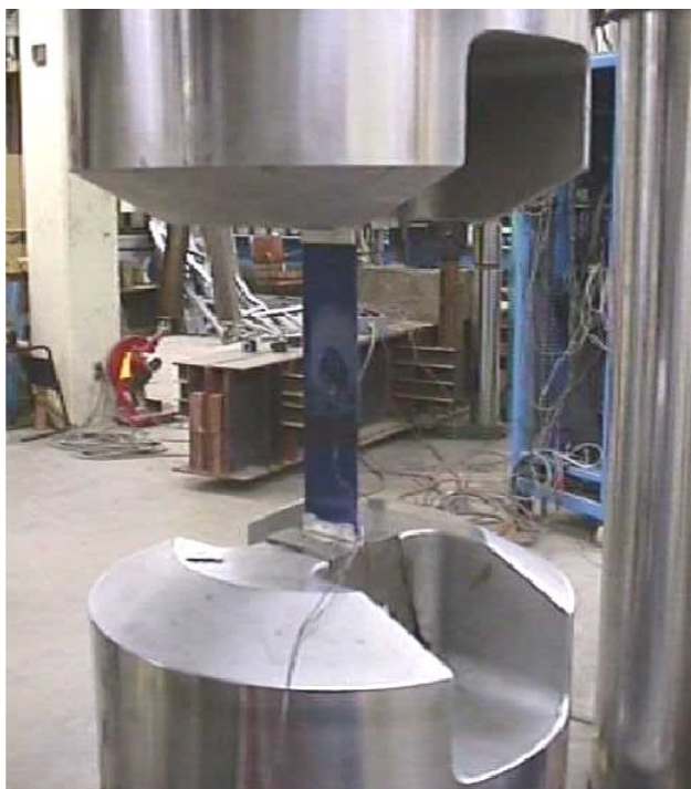
Esecuzione del test secondo ASTM D3039
