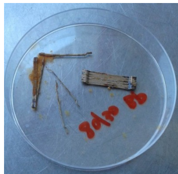
Fibre corrodibili, prova non superata
